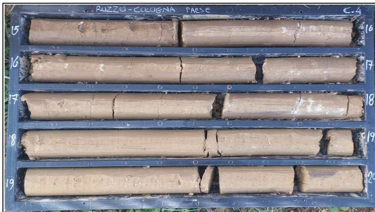
Sondaggio S1 - Cassetta 4 (15,0-20,0 metri)
