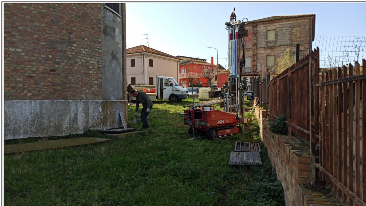
Prova penetrometrica dinamica DPSH – P1
