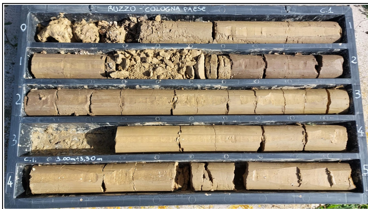
Sondaggio S1 - Cassetta 1 (0,0-5,0 metri)
