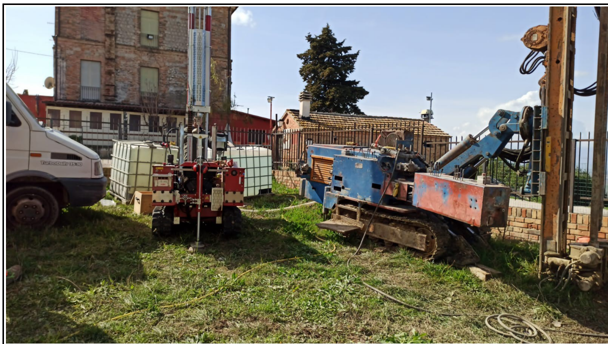
Prova penetrometrica statica CPT – P2
