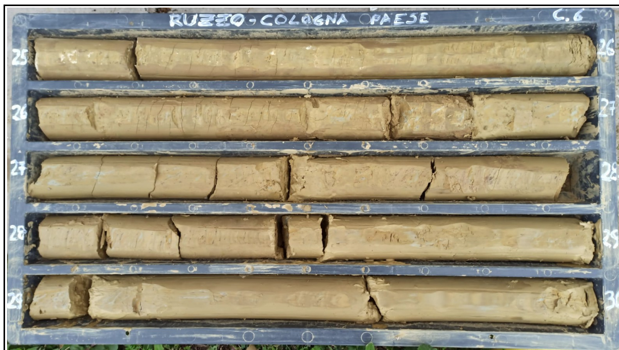
Sondaggio S1 - Cassetta 6 (25,0-30,0 metri)
