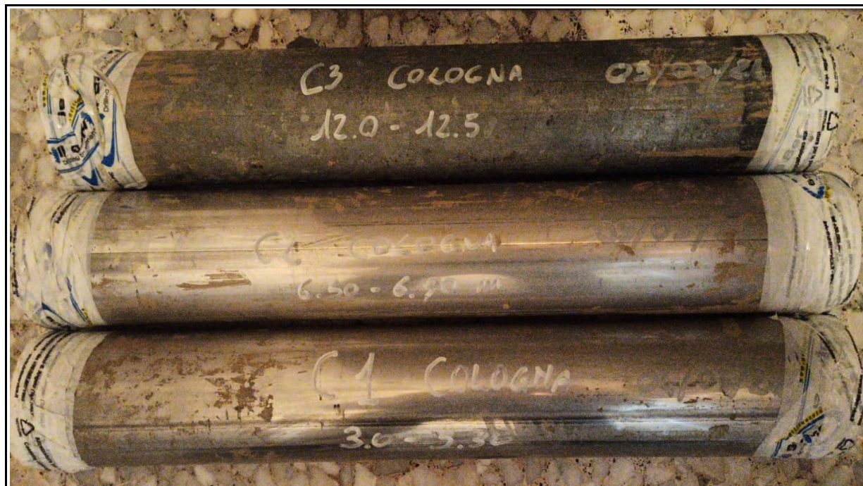
Sondaggio S1 – Fustelle con campioni indisturbati per prove di laboratorio
